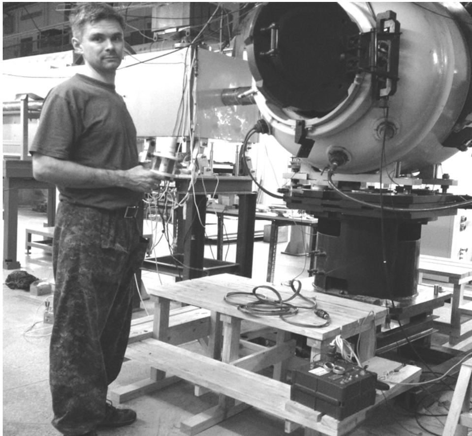
Рис. 3. Взрывная камера на взрывчатку 200 г в тротиловом эквиваленте. Э.Р.Прууэл (ИГиЛ СО РАН) перед установкой сборки во взрывную камеру.
